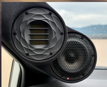
高音用のツイーターと中音用のスクーカーはAピラーを加工して取付けています。
